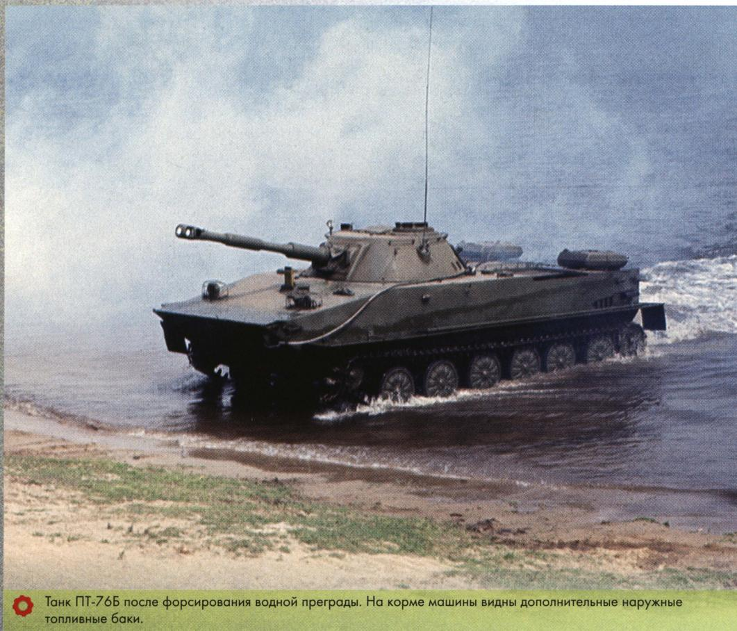
Танк ПТ-76Б после форсирования водной преграды. На корме машины видны дополнительные наружные топливные баки.
