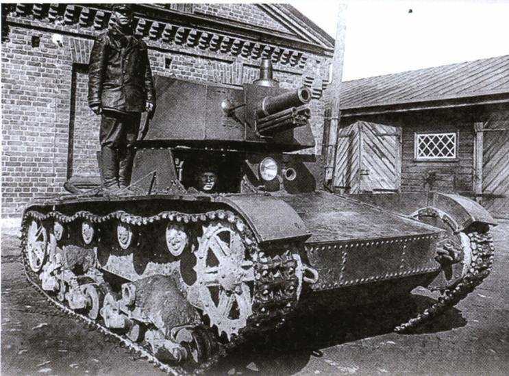
Танк Т-26 с башней А-43 — хорошо видна отдельная установка пулемета ДТ, 1932 год.
