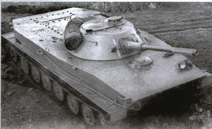
Танк ПТ-76 с пушкой Д-56Т первых выпусков, вид сверху спереди. Хорошо виден люк механика-водителя с тремя смотровыми приборами.
