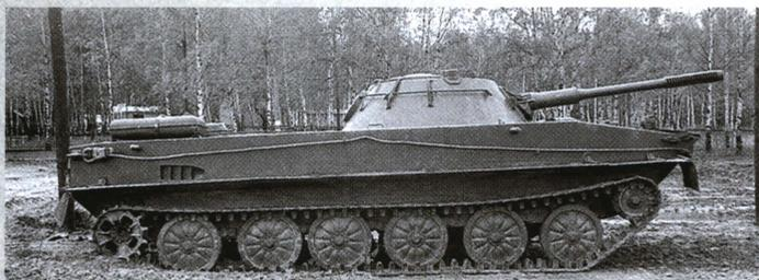
Танк ПТ-76 с пушкой Д-56, вид справа. Машина прошла модернизацию и оснащена дополнительными наружными топливными баками.
