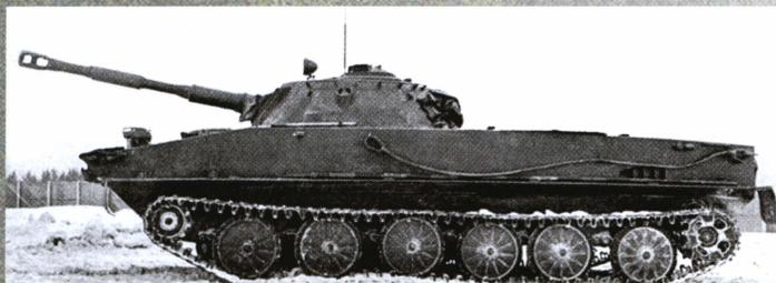
Танк ПТ-76Б, вид слева. Хорошо видны крепление буксирного троса и антенный ввод на башне.
