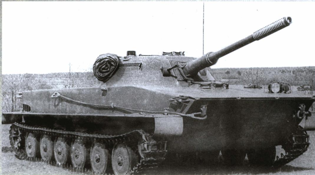
Танк ПТ-76 с пушкой Д-56Т с щелевым дульным тормозом.
